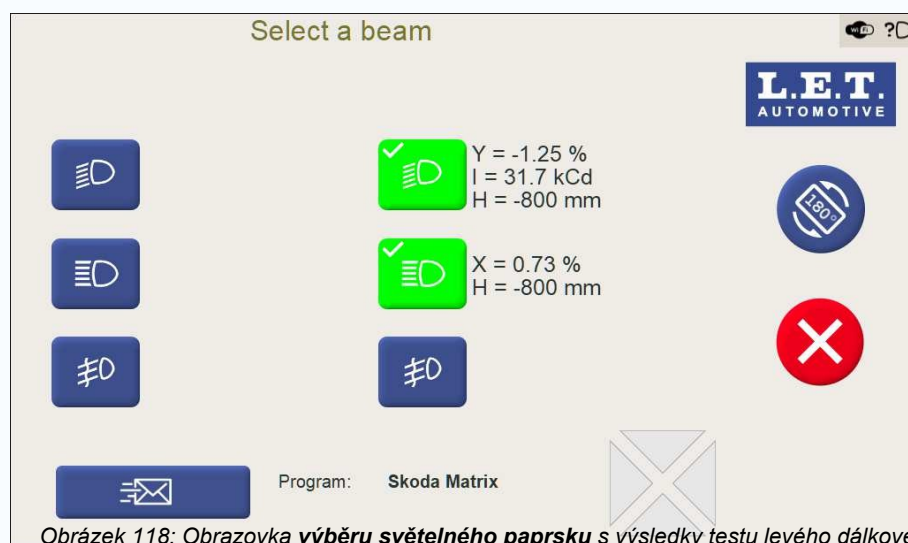
Obrázek 118: Obrazovka výběru světelného paprsku s výsledky testu levého dálkového světla Matrix
