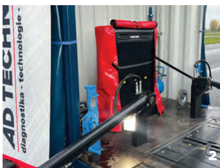
2 a 3 Snímací kamery pro měření geometrie se nacházejí po stranách. Měří na základě odrazu laserového paprsku. Skener pneumatik je instalován do podlahy.
