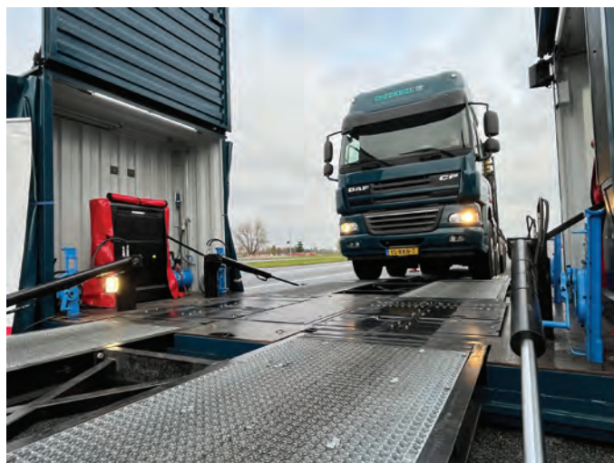
1 Zařízení Hunter Quick Check Commercial během jednoho průjezdu zaměří celkovou sbíhavost přední řízené nápravy a vzájemné postavení zadních náprav vůči sobě.
