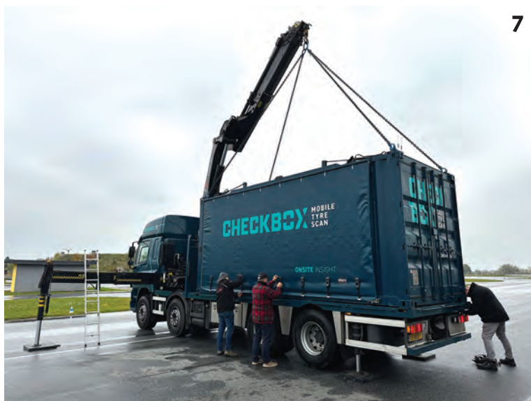
6 a 7 Na prezentaci do Hradce Králové dovezli z Nizozemska zástupci společnosti Heuver mobilní verzi Hunter Quick Check Commercial, nainstalovanou do lodního kontejneru.
