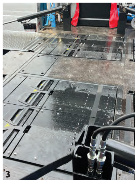
2 a 3 Snímací kamery pro měření geometrie se nacházejí po stranách. Měří na základě odrazu laserového paprsku. Skener pneumatik je instalován do podlahy.
