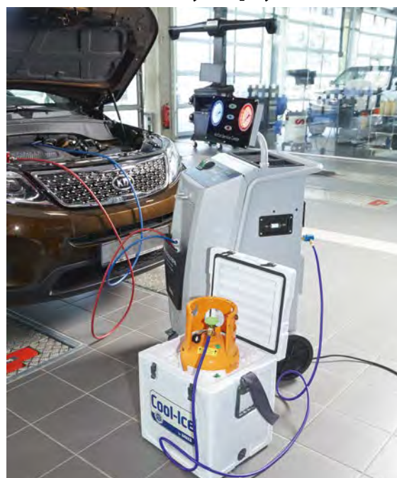
Kondenzace odpadních plynů do nádoby přes zařízení pro servis klimatizací umožňuje monitorovat průběh kondenzace pomocí manometru přístroje
