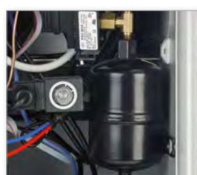
Separátor oleje pro ochranu modulu analyzátoru
