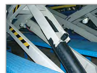
Zjištění polohy pomocí mechanických západek
