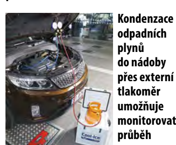
Kondenzace odpadních plynů do nádoby přes externí tlakoměr umožňuje monitorovat průběh
