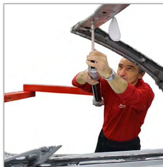
Elektronické měření umožňuje měřit body na střeše vozidla...
